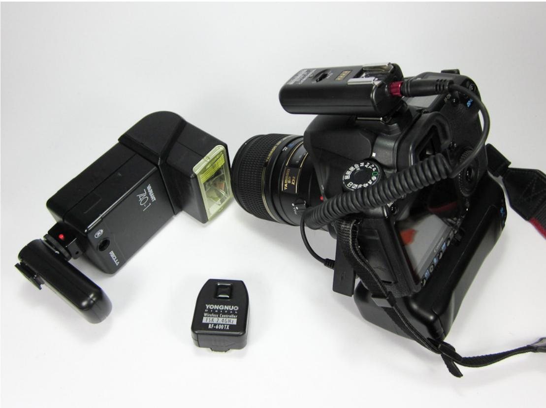
Somit können Kamera und Blitz gleichzeitig per Funk ausgelöst werden.
