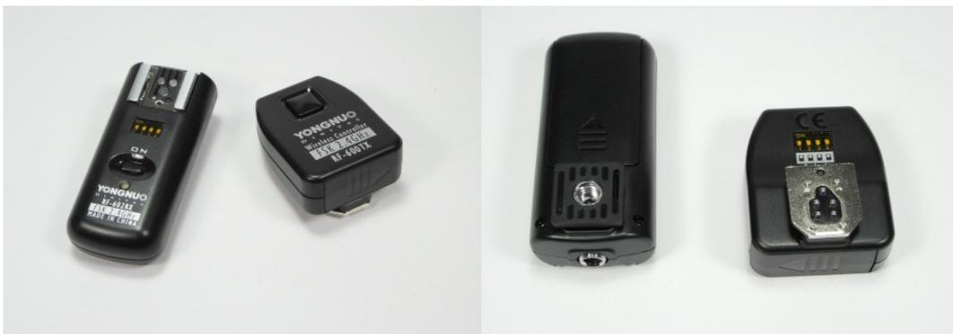
Mit diesem System kann der Blitz per Funk fernausgelöst werden. Dazu wird der Sender (rechts) in den Blitzschuh der Kamera gesteckt und der Blitz in die Fassung des Empfängers (links) geschoben. Netterweise hat der Empfänger auf der Unterseite ein Stativgewinde, so dass sich der Blitz problemlos auf ein vorhandenes Stativ montieren lässt:
